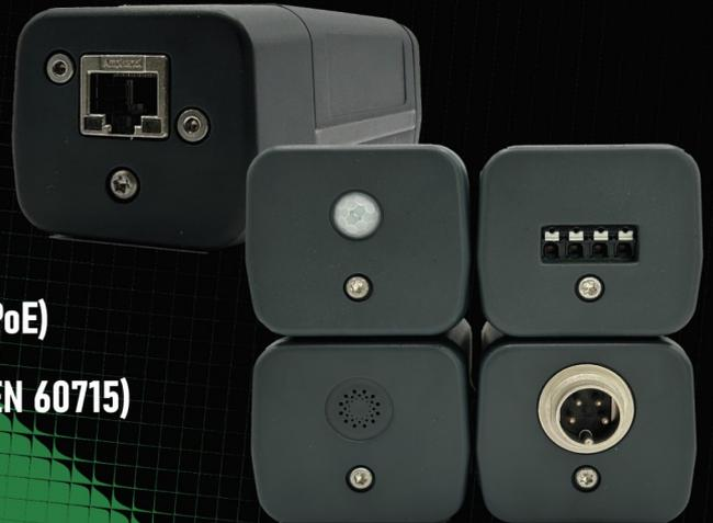
Mit dem eNetCube nutzen Sie ein vielseitiges Gerät zur Erfassung, Steuerung und Überwachung von Aktoren und Sensoren in Ihrem individuellen Prozess.
